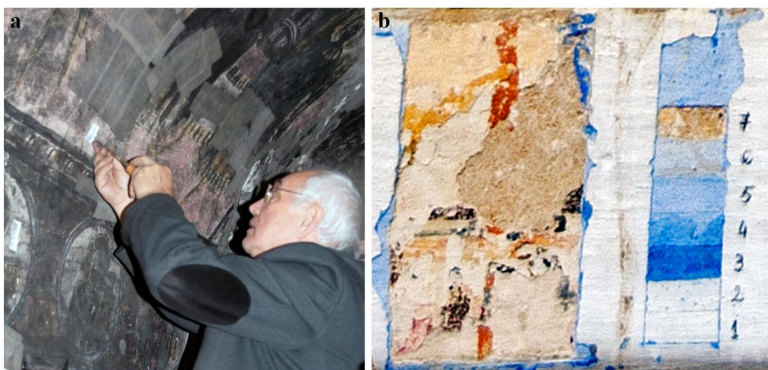
Fig. 3.12. Zonele de prelevare a materialului pictural: a. din frescele de la interior b. și a varului din stratele suprapuse peste fresca din exterior
